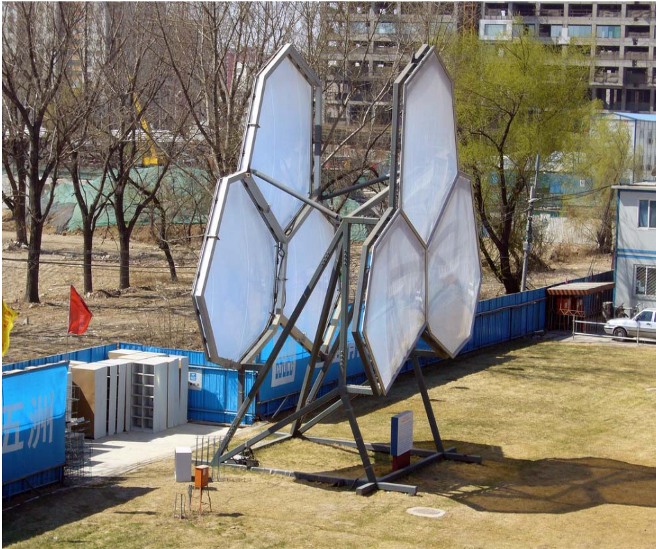
La fase di sperimentazione delle membrane utilizzate per la superficie delle bolle del water cube.
